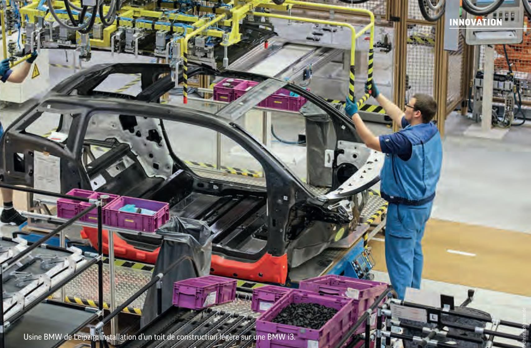
Usine BMW de Leipzig: installation d'un toit de construction légère sur une BMW i3.
