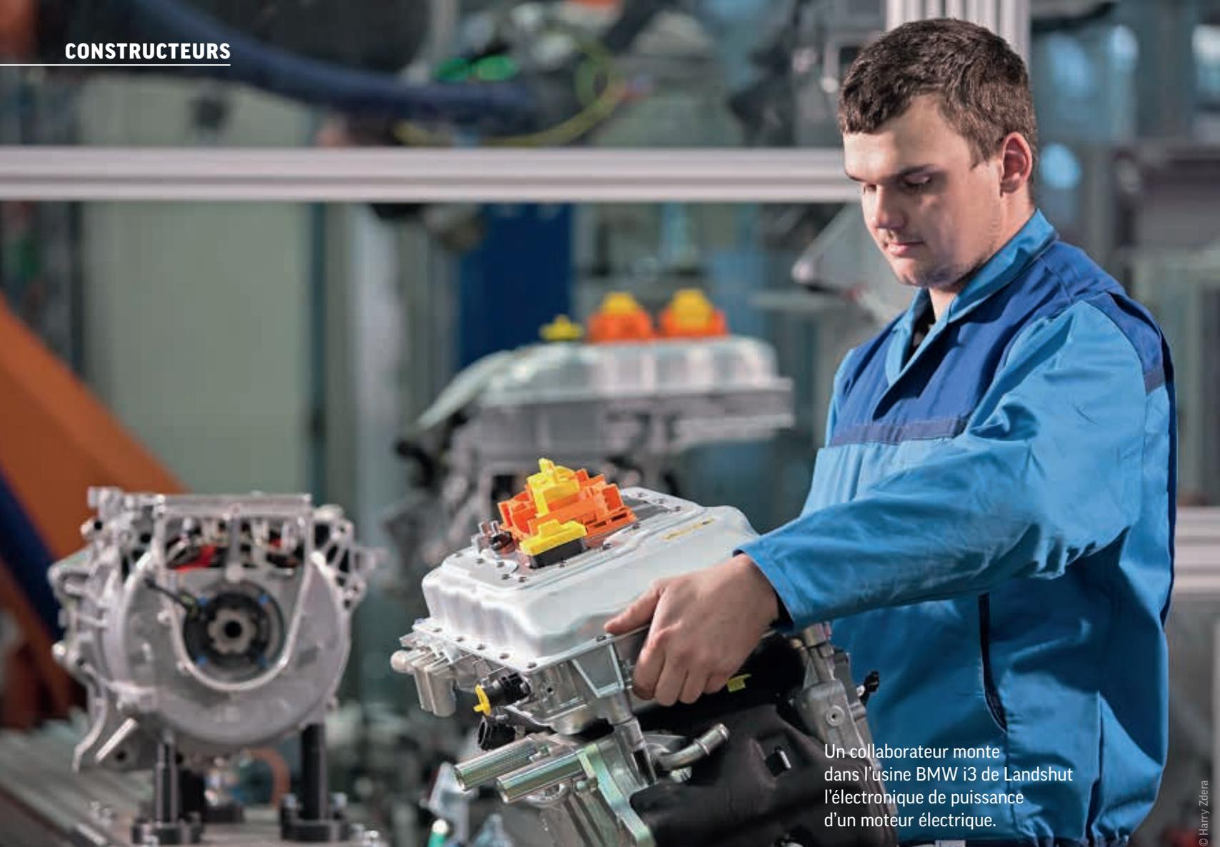
Un collaborateur monte dans l'usine BMW i3 de Landshut l'électronique de puissance d'un moteur électrique.
